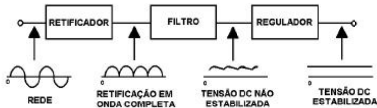
Figura 1: Diagrama de blocos de uma fonte de tensão regulada
